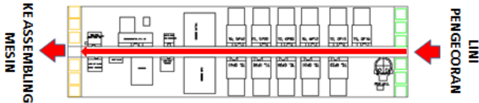
Gambar 30. Tata Letak Lini Produksi Cylinder Head Machining ( PT A, 2011 )
