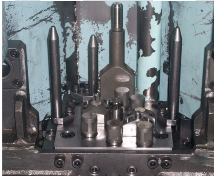
Gambar 51. Desain Jig&Fixture Sebelum Proses Decoupling
