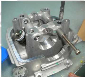
Gambar 59. Inspeksi 100% Pemasangan Shaft Rocker Arm dan Boltstud
