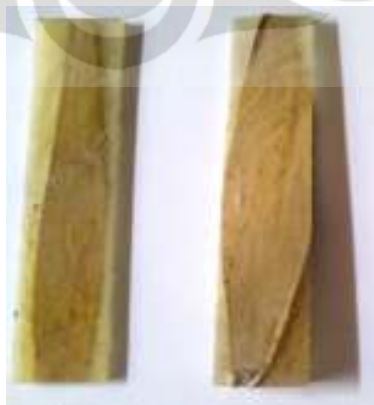
Gambar 3.18 Komposit yang sudah kering dan sudah dipotong
