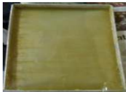
Gambar 3.16 Resin dan hardener yang sudah diletakan dalam cetakan
