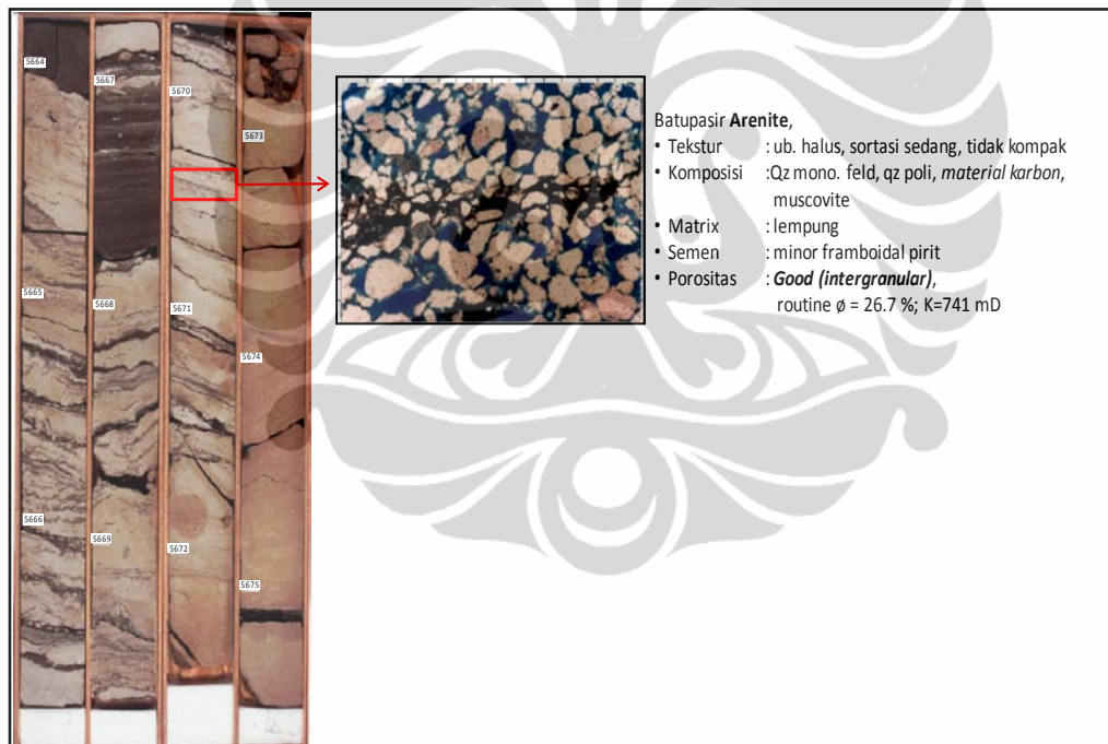
Gambar 4.5. Data core interval 5567,7 sstvd sampai 5675,5 sstvd Sumur HD#2
