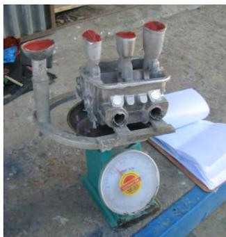
**Gambar 3-7.** Penimbangan berat tuangan untuk menghitung *yield* dengan timbangan kapasitas 10 kg.
