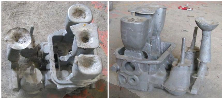
**Gambar 4-2.** Hasil pengecoran dengan *casting design* awal.
