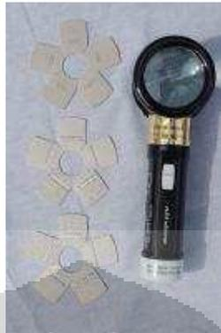
Gambar 4.2 Perangkat alat *KTA comparator sand*
