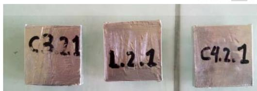
**Figure 3.8** : Position des faces exposées à la carbonatation et des faces protégées par un film d'aluminium
