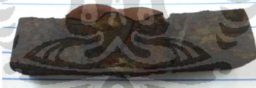
Gambar 4.34 Foto hasil uji celup sampel 2 ( weld root MG NOX 35 dan weld cap ER 7018)
