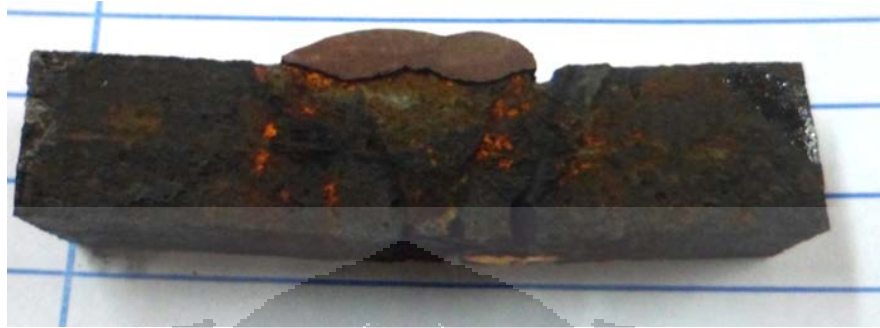
Gambar 4.37 Foto Hasil Uji Celup sampel 3 ( weld root 7018 dan weld cap MG NOX 35 )
