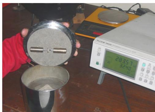
Gambar 3.2 Pengukuran RCL-meter dengan menggunakan kontak mekanik.
