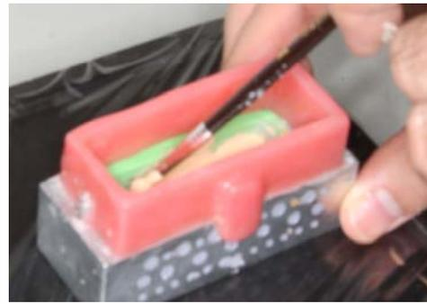
Gambar 4.16. *Dental stone* terlebih dahulu diisi ke dalam cetakan menggunakan kuas.
