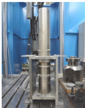
Figure 2.3 Moule en acier pour réaliser les éprouvettes M_4 (fort compactage)
