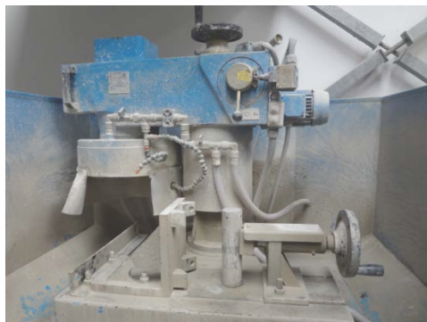
Figure 2.8 Dispositif de surfaçage
