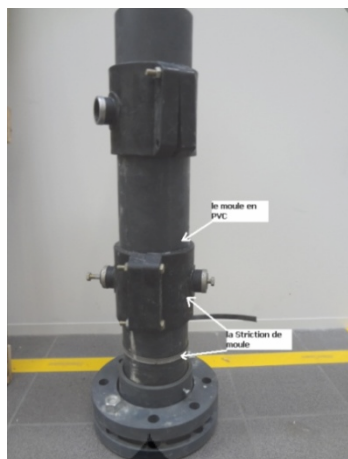
Figure 2.1 moule en PVC pour réaliser l'éprouvette 100 mm de diamètre, 200 mm de hauteur
