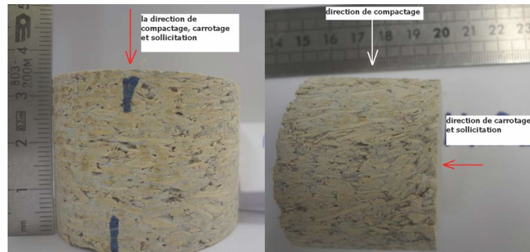
Figure 3.14 description l'échantillon qui se fait en carottage axial et radial
