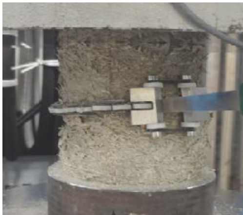
Figure 2.15 Eprouvette M 2 en fin de l'essai de compression.
