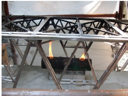
Gambar D.5. Kebakaran Kondisi Angin Kecil (kiri) dan Efek Angin Dari Sebelah Kiri (kanan)
