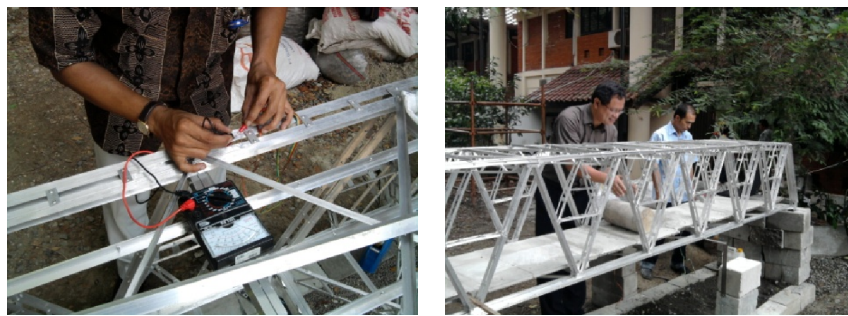
Gambar D.1. Pemasangan Strain Gage (kiri) dan Uji Statik (kanan)
