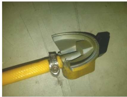
Gambar 3.7 Regulator yang Dibentuk untuk penghubung ke tangki LPG
