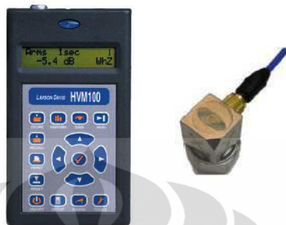
Gambar 3.2 Human Vibration Meter dan Accelerometer
