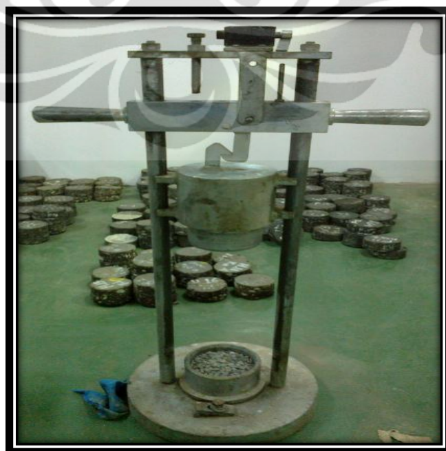
Gambar 3.10. Pengujian agregat dengan metode tumbukan
