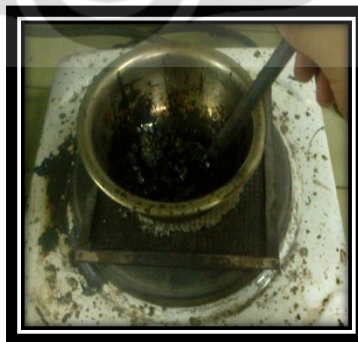
Gambar 3.7. Pengadukan agregat dan aspal
