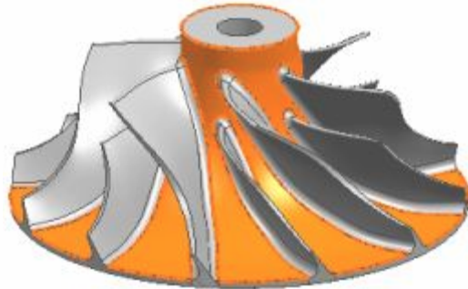
Gambar 2.19 Geometri hub pada impeller [8]
