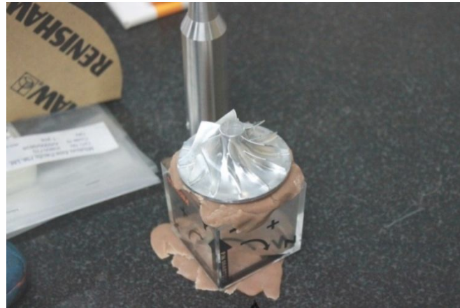
Gambar 4.21 Penggunaan lilin untuk melekatkan komponen pada meja ukur
