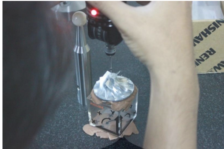
Gambar 4.23 Penentuan titik (0,0,0) pada benda uji
