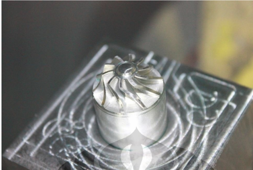
Gambar 6.6 Impeller setelah proses roughing
