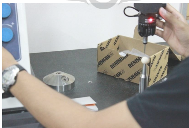
Gambar 4.22 Penentuan koordinat (0,0,0) pada mesin
