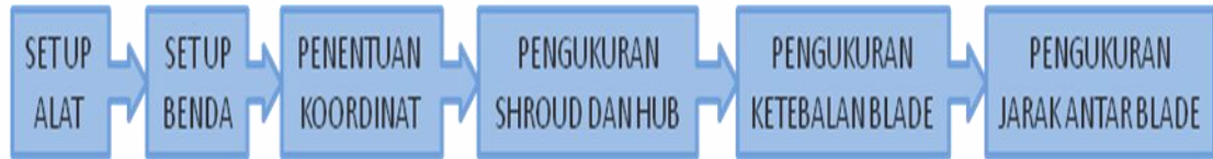
Gambar 4.19 Flowchart pengukuran menggunakan CMM
