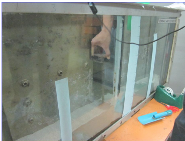
Gambar 4.6 Penumbukan pasir dengan beban cincin 1 kg
