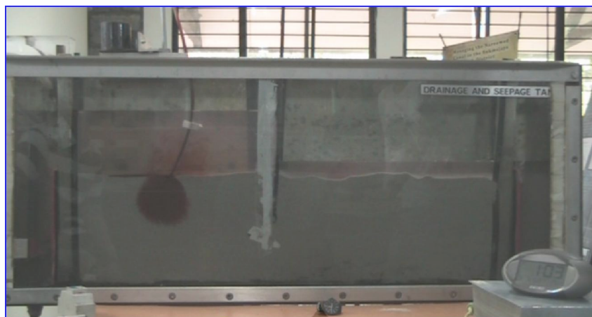
Gambar 4.15 Larutan dye tidak dapat masuk akibat tekanan yang terlalu besar
