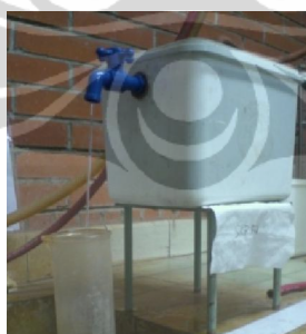
Gambar 4.5 Pengukuran debit air yang keluar
