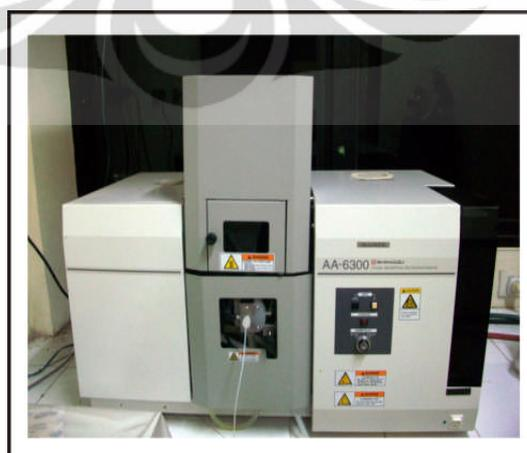
Gambar 3.4 Spektrofotometer Serapan Atom (Shimadzu AA 6300)
