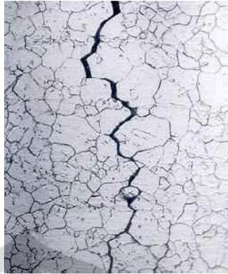
Gambar 2.8 Korosi intergranular<sup>13]</sup>
