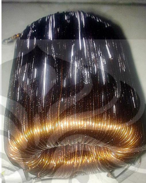
Gambar 3.9 Induktor Toroid Penampang Samping
