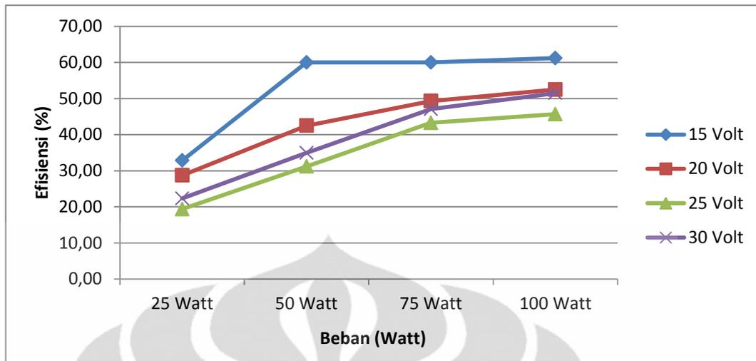
Gambar 4.3 Grafik Perbandingan Efisiensi Perubahan Tegangan Input Terhadap Perubahan Beban
