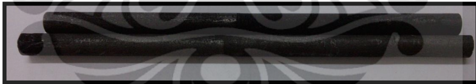
Gambar 3.14. Grafit yang digunakan dalam pengujian Hydrogen Charging
