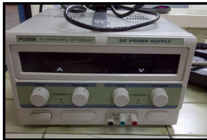
Gambar 3.15. Rectifier yang digunakan dalam pengujian Hydrogen Charging
