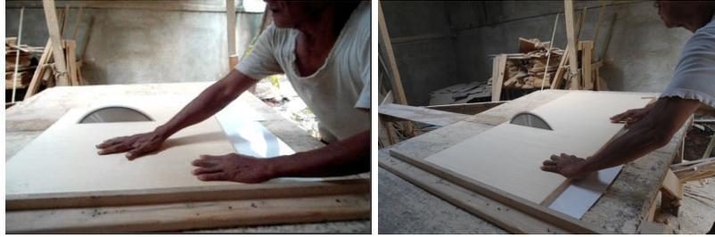
**Gambar 5.12** Pemotongan dengan *Circular Saw*
