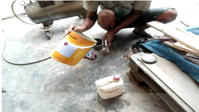
**Gambar 5.28** Proses pencampuran bahan sendng
