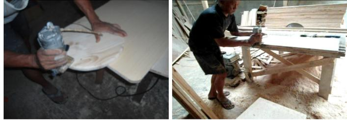
**Gambar 5.17** Proses penghalusan menggunakan router
