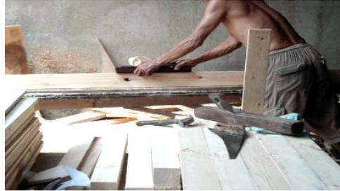
**Gambar 5.14** Penyerutan menggunakan *Planner* Manual pada lembaran yang belum disambung
