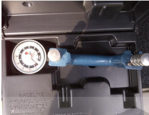
Gambar 2.4 Hand-Grip Dynamometer (tampak depan)
