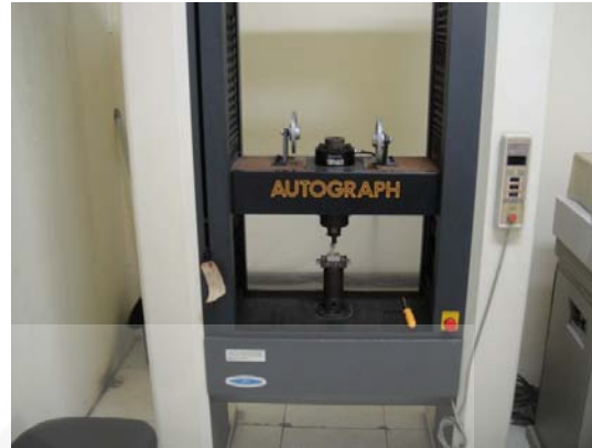
Spesimen siap diuji kekuatan ikat geser resin komposit-dentin
