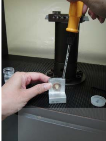
Pemasangan spesimen pada Universal Testing Machine
