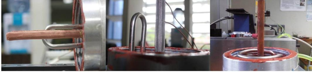
**Gambar 3.7** Media berpori *screen mesh* tembaga, *stainless steel* dan *sintered copper* tembaga
