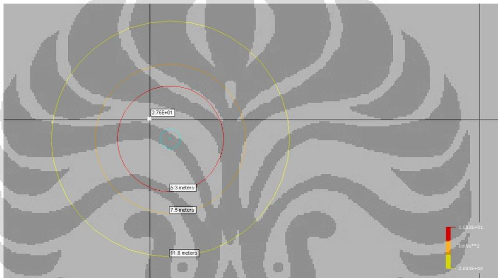
**Gambar 5.14 Hasil Simulasi Kebakaran Pada Tabung Butana 12 Kg Berupa *Thermal Radiation Level***
