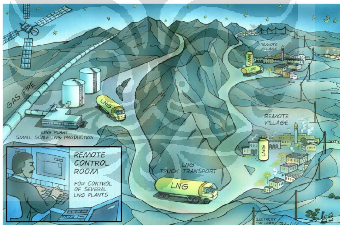
Gambar 2.12 Tipikal Rantai Distribusi LNG dari Kilang Mini LNG
