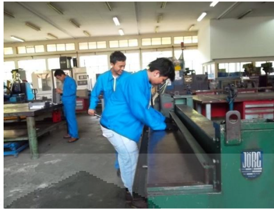
Gambar 6.2 Pemotongan Dengan Mesin Potong Manual
