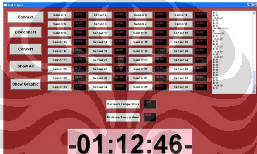
Gambar 4.7 Tampilan GUI Python saat menampilkan nilai temperatur yang terbaca 36 sensor DS18B20, temperatur tertinggi, dan temperatur terendah
