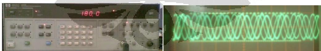
Gambar 4.7 Pengujian sistem terhadap sinyal diatas frekuensi *cutoff*
