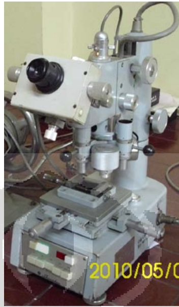
Gambar 3.6. Alat Vickers Hardness untuk pengujian microhardness
