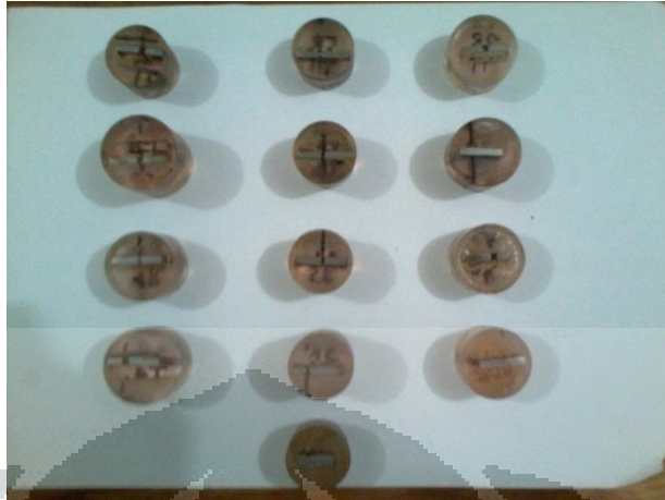
Gambar 3.8 Sampel Yang Sudah Di-mounting
