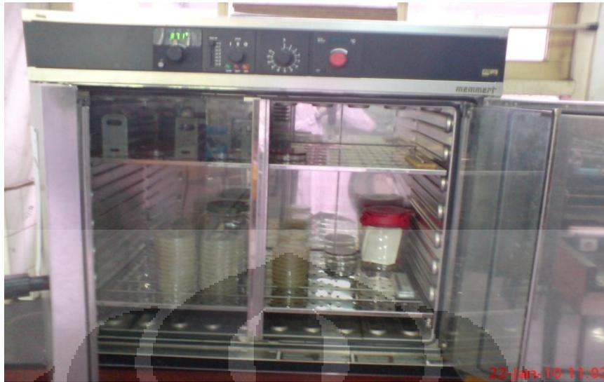
Gambar 3.2 Lemari inkubator untuk menjaga suhu tertentu bagi viabilitas bakteri
