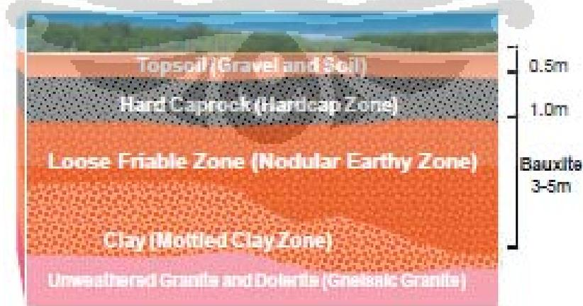
**Gambar 1.1** Kondisi Bawah Permukaan dari Endapan Bauksit Laterit
