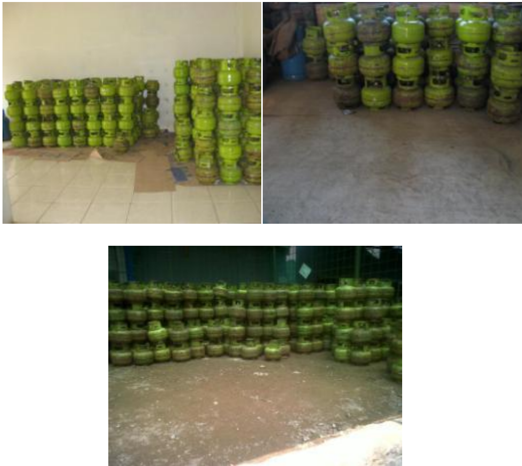
Gambar 5.37. Lantai Penyimpanan Tabung Kosong Terlihat Kering
