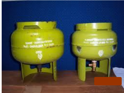
Gambar 5.36. Perbandingan Tabung Asli (Kiri) dan Tabung palsu (Kanan)
