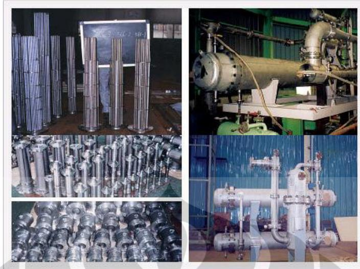
Gambar 3.14. *Steam Jet Ejector*
