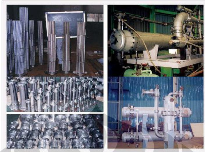
Gambar 3.14. *Steam Jet Ejector*
