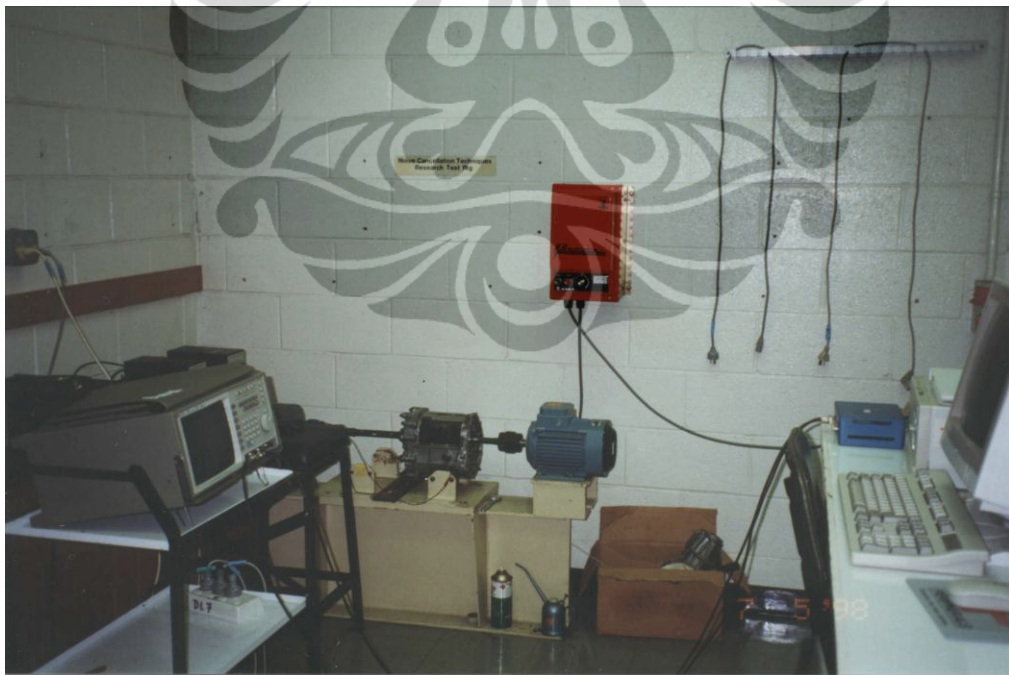
Gambar 3. 28. Peralatan ukur yang digunakan yaitu DAQ DAS18 dengan sampling rates 800 kHz - 1 MHz yang terpasang dalam PC dan signal analyzer untuk memantau gelombang tegangan yang terdeteksi oleh sensor AE
