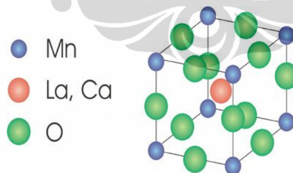
Gambar 2.4 Struktur kristal La_{1-x}Ca_xMnO_3
