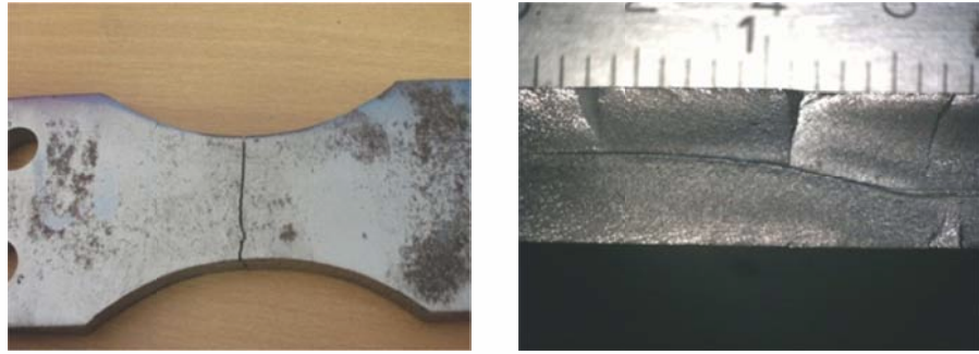
Gambar L.1 Hasil uji fatigue – tanpa spatter
