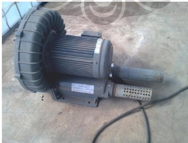
Gambar 3.11 Ring blower pada *fluidized bed combustor* UI
