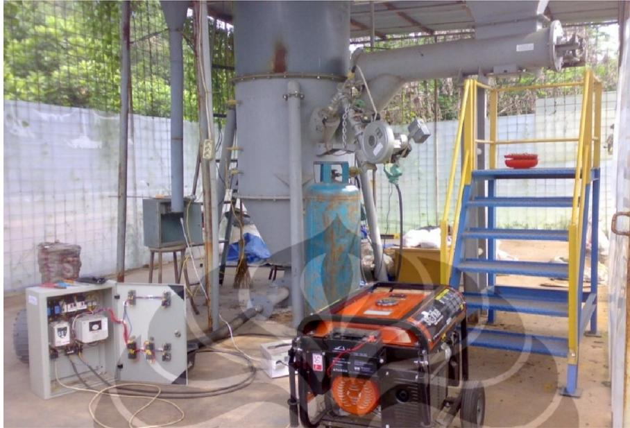
Gambar 3.13 Rangkaian seluruh alat untuk melakukan pengujian pembakaran
