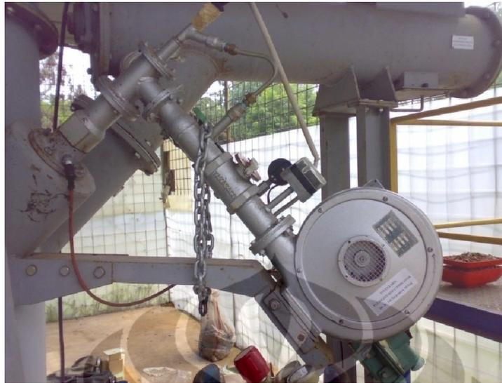
Gambar 2.16 *Burner* yang digunakan pada *Fluidized Bed Combustor* UI
