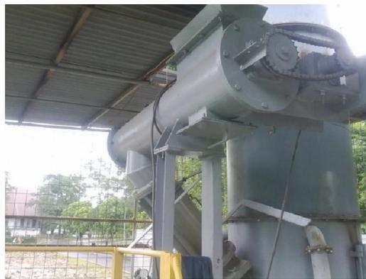
Gambar 3.10 Sistem feeder pada *fluidized bed combustor* UI
