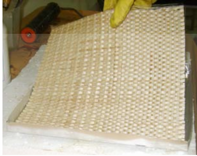
Gambar 3.18b Lapisan Serat Pertama
