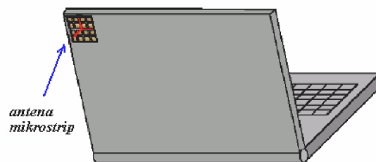
Gambar 1.3. Antena mikrostrip pada laptop [2]
