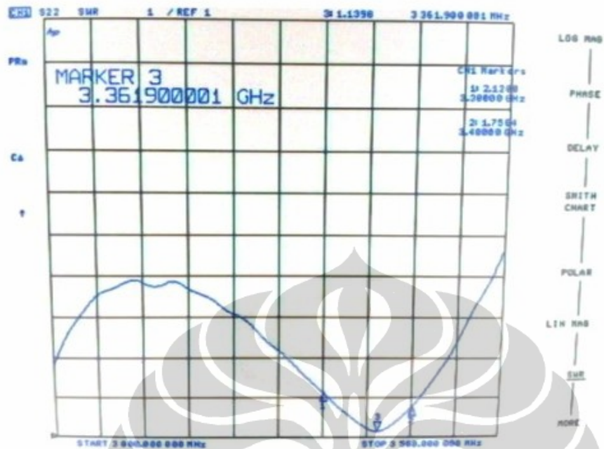
Gambar Lamp 1.2.3 Grafik VSWS antenna mikrostrip array 2 elemen pada frekuensi 3,3 GHz
