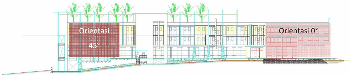
Gambar 4-24 Susunan panel dimensi 40cm x 40cm dengan tipe solid overhang dan inclined wall .
