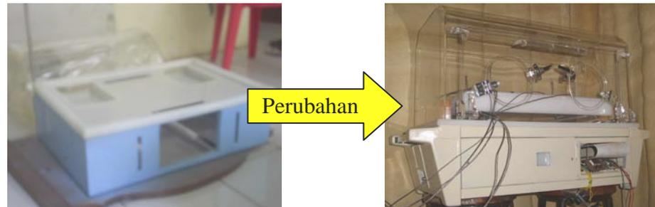
**Gambar 4.14** Perbaikan Desain Box Inkubator
