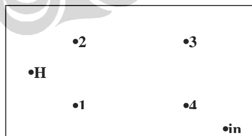
Gambar 4.24 Skema Pengujian di Dalam Hood Inkubator
