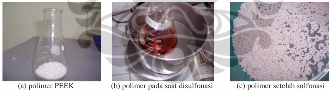
Gambar 3.1. Bentuk Polimer PEEK sebelum dan sesudah sulfonasi
