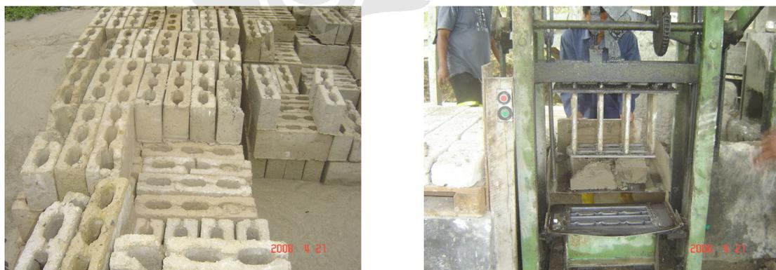
Gambar 8 Batako yang Diambil dan Proses Pencetakan Batako
