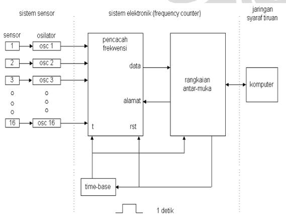
**Gambar 2. Skematik diagram sistem elektronik menggunakan 16 buah sensor**
