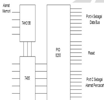
**Gambar 4. Rangkaian dekoder dalam sistem elektronik**
