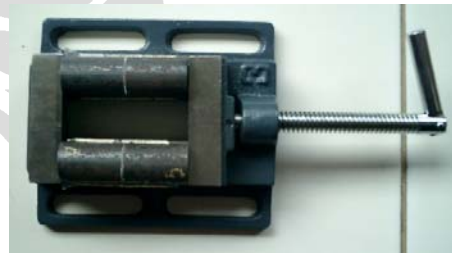
Gambar 4. Penjepitan sampel untuk memastikan pelekatan epoksi secara sempurna.
