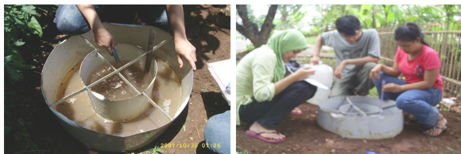
Gambar 4.2. Pengamatan dan Pengukuran Data Infiltrasi Tanah
